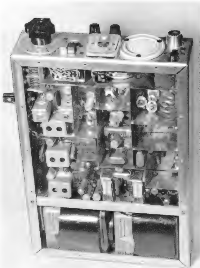
Bild 4. Ansicht des offenen Gehäuses, oben die Bedienelemente, in der Mitte die bestückte Schaltplatte, unten das Batteriefach
