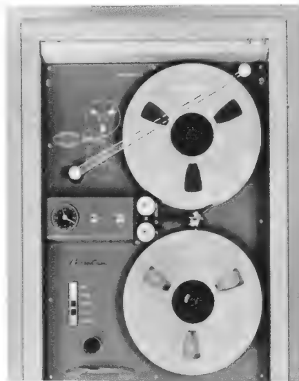
Bild 4. Laufwerk und Bandvorratsüberwachung
