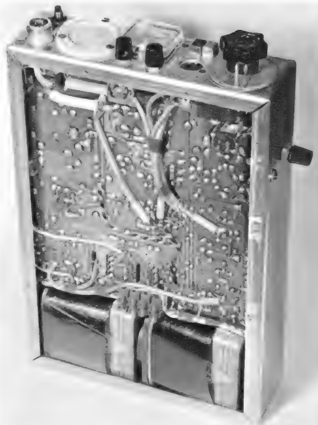
Bild 5. Gehäuse offen von hinten gesehen. Man erkennt die Verdrahtung der Platte und den Batteriekasten
