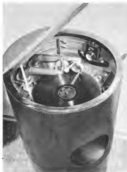
Bild 2. Blick in das Oberteil: Beide Tonarme sind miteinander verbunden, beide Nadeln laufen in der gleichen Rille hintereinander im Abstand von 84 mm
