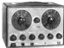
Wobbelsender mit Markengeber und Mischverstärker 369 DM 499.-
